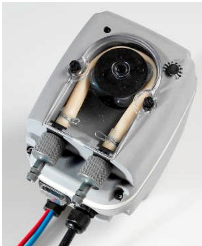
Die Schlauchpumpe Typ **EE900** wurde für das Fördern von Kondensat aus Klimaanlagen konzipiert. Sie verfügt über 2 Sensoren, die auf die Temperaturdifferenz (5°C) zwischen Wärmetauscher und Umgebungsluft reagiert. Damit wird die Pumpe bedarfsgerecht ein- bzw. ausschalten. Die Nachlaufzeit beträgt ca. 3 Minuten.
