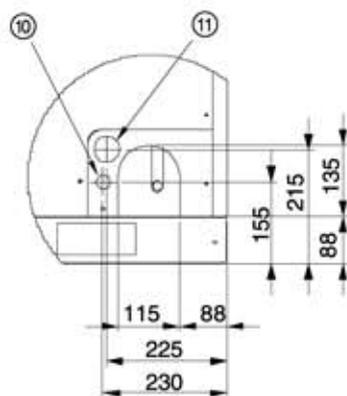
**Lochdetail bei Rohrführung nach unten (Draufsicht)**
