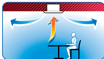
Im Vergleich dazu die Luftverteilung eines herkömmlichen Modells mit wesentlich größeren Temperaturunterschieden im Raum.
